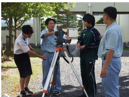
B：トータルステーションを用いた 電子平板測量
