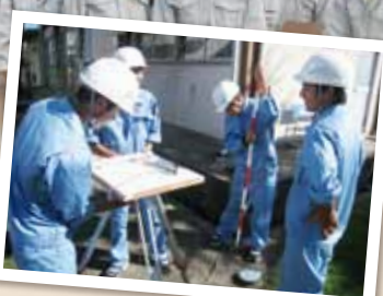
『平板測量実習』 現場で測量しながら図面を仕上げる平板による細部測量
