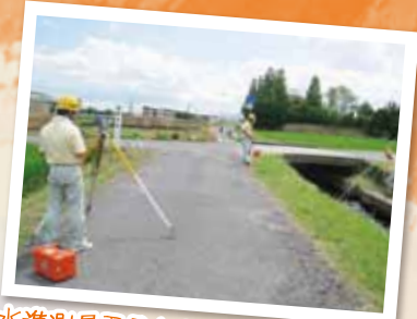
『水準測量夏季実習』 電子(バーコード)レベルと標尺を使用した道路及び水路の現況(高さ)測定
