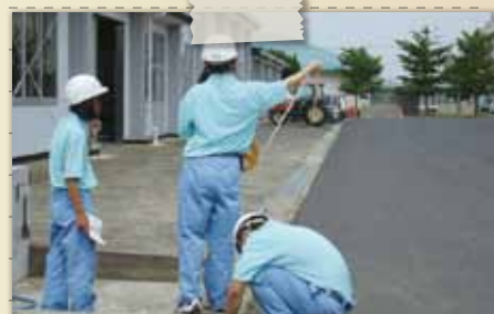
巻尺による距離測量
